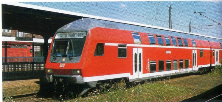
Die zunächst für den Großraum Stuttgart beschaffte Bauart DBbzf 761 führte nur die 2. Klasse. Gemischt-klassige Wagen werden als DABpbzf 762 bezeichnet (DBbzf 761, 50 80 80-35 349-5).
