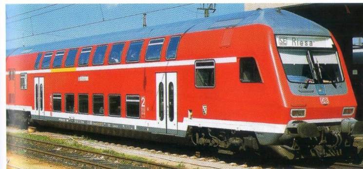
Die Bundesländer Sachsen und Rheinland-Pfalz haben sich zur Beschaffung klimatisierter Wagen der Bauart DABpbzf 762 entschieden (50 80 80-35 374-3).
