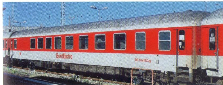
Bei den Servicewagen der Bauart WRmbz 138 wurde der 1.-Klasse-Bereich u. a. durch einen Servicepoint ersetzt, an dem die Reisenden ihr Abteil im Zug zugewiesen bekommen (61 80 88-91 002-0).
