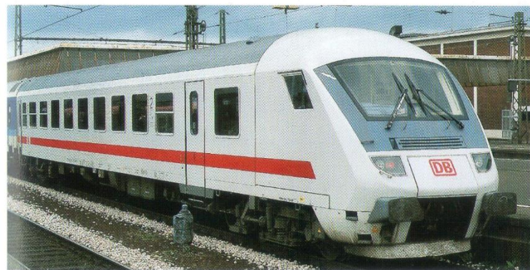
Der Führerstand entspricht der Baureihe 111. Er kann zur Steuerung aller wendezugfähigen Elloks am anderen Zugende eingesetzt werden (Bimdzf 269, 51 80 80-95 811-0).
