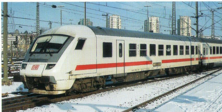
Die Steuerwagen der Bauart Bimdzf 271 entstanden aus Wagen der ehemaligen Deutschen Reichsbahn der DDR und trugen zunächst die Bezeichnung Bimdzf 269 (51 80 80-95 809-4).
