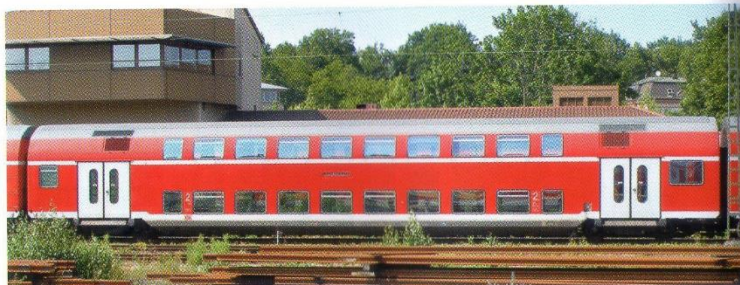
Die Doppelstockwagen der Bauarten DBz 750 und DABz 755 wurden 1993 von der DWA in Görlitz gebaut und als erste Neubau-Doppelstockwagen an die DB geliefert (DBz 750, 50 80 26-35 049-8).
