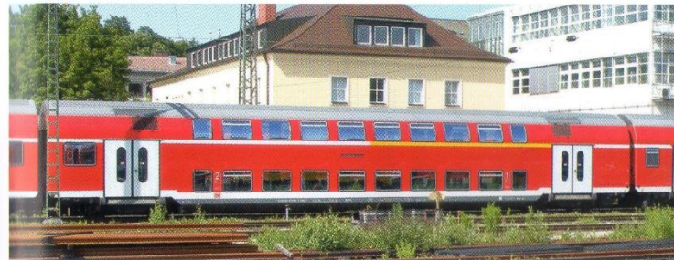
Beide Bauarten lehnen sich an die von Schindler Waggon in der Schweiz gebauten Wagen an. Sie unterscheiden sich durch das gesickte Dach von späteren Bauarten (DABz 755, 50 80 36-35 016-5).
